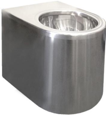
Desenvolvida principalmente para prisões, esta bacia sanitária tem estrutura robusta que impede o vandalismo, feita em aço inox AISI 304 com espessura de 1,5 mm. Possui saída de água horizontal para acesso por galeria técnica ou saída de água vertical com acesso lateral.
