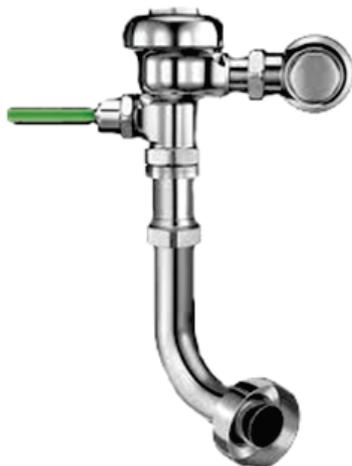
Indicada para locais com alto tráfego de pessoas, esta válvula é acionada de forma manual e com duas opções: meia descarga e descarga completa. Seu funcionamento é prático, pontual e gera economia, pois reduz em 30% o consumo de água no fluxo para resíduos líquidos.
